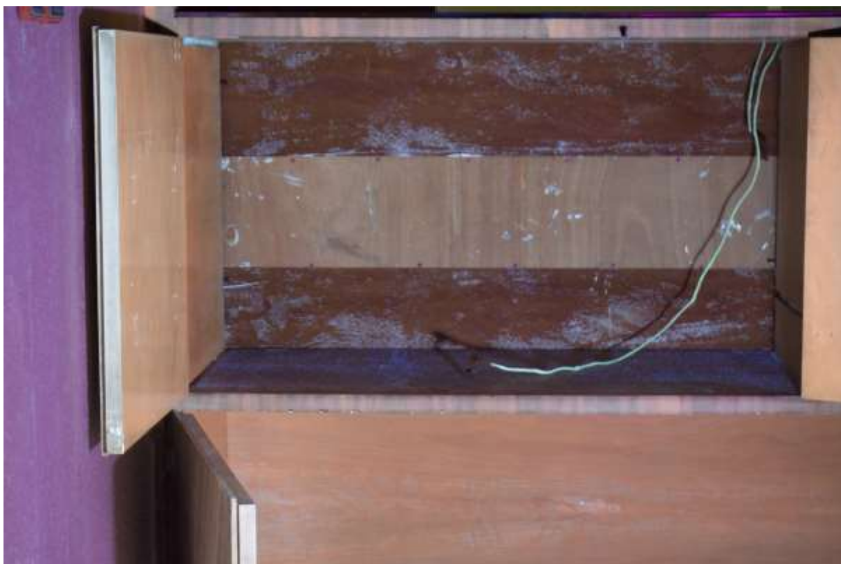
Bílá fluorescence lepidla na zádech, světle bělavá fluorescence na hranách, naoranžovělá fluorescence vnitřních ploch dvířek
